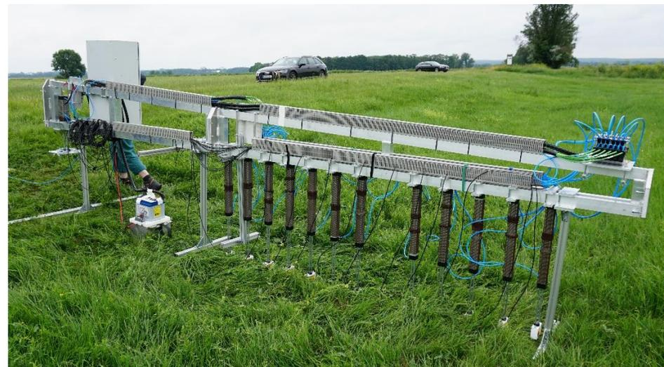
**Automatisierter Betrieb** der Geophone und des Aktors mit manuellem Versetzen
