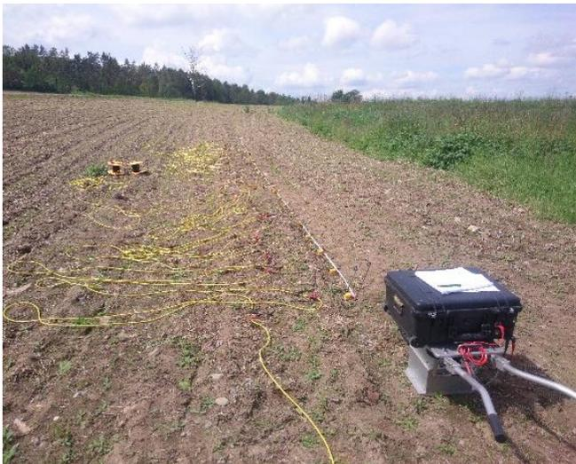
**Stand der Technik:** Manueller Betrieb der Geophone und des Aktors als Einzelteile
