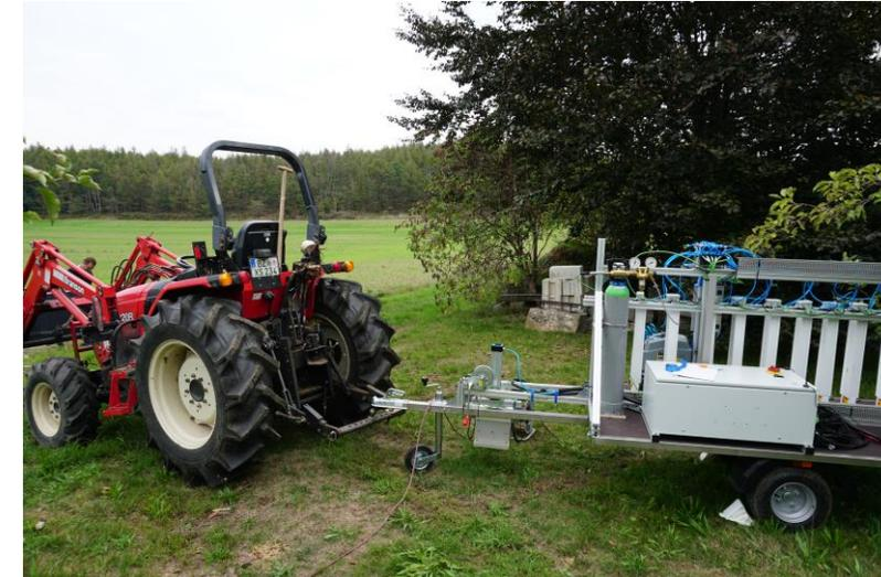
Automatisierter Betrieb der Geophone und des Aktors **mit Anhängerlösung**
