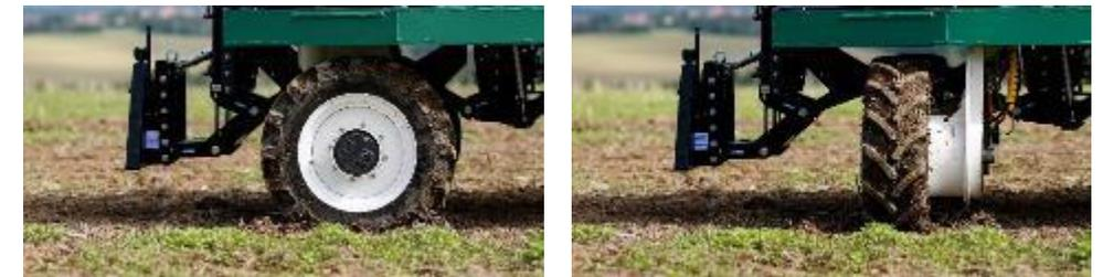
Umsetzung der verschiedenen Lenkmodi (Ackermannlenkung, Tellerdrehung, Querfahrt, Ein- und Mehrachslenkung ... )
